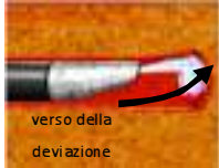
Principio di funzionamento di una punta asimmetrica
